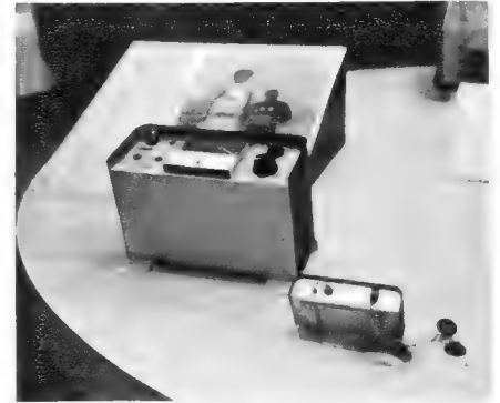
Bild 1. Herzschlag-Fernmeßgerät. Vorn der vom Athleten zu tragende Kleinstsender, links das Empfängergerät für den Sportarzt mit großem in Pulsschläge/min geeichten Instrument
